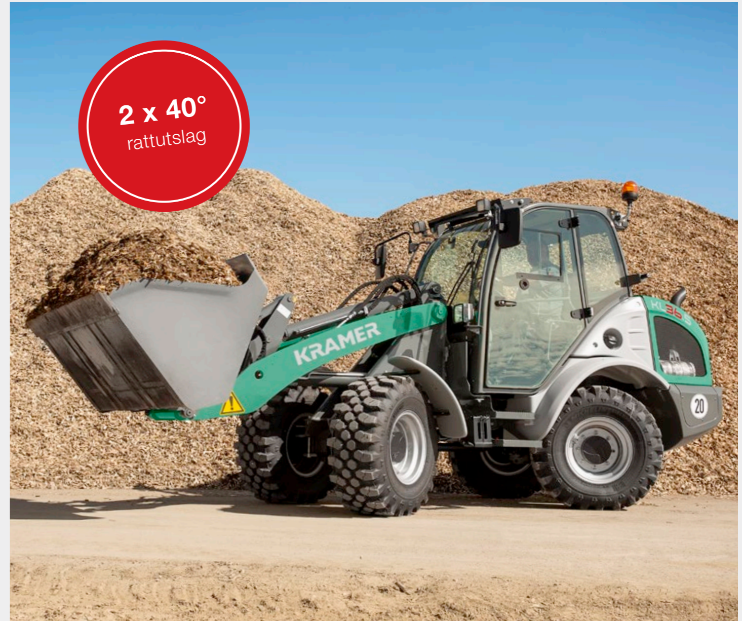
Fyrhjulsstyrning särskilt smidig vid begränsade platsförhållanden
