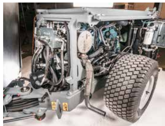
Miljömotor med insprutning och nytt avgassystem bidrar bl.a. till mycket låga utsläpp.
