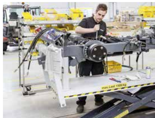
TransPro 70100 har samma plattform med integrerade hjulmotorer som TransPro 5080.
